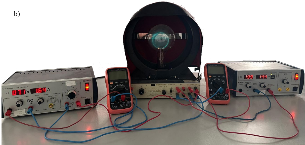
Şekil 3: e/m deneyi için bağlantılar: a) Şematik gösterim, b) Gerçek bağlantılar.
