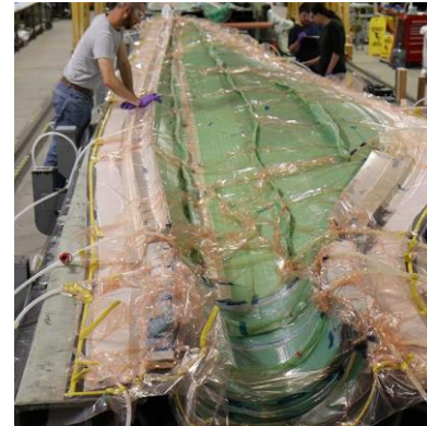
VARIM metodu ile rüzgar türbin kanat imalatı
