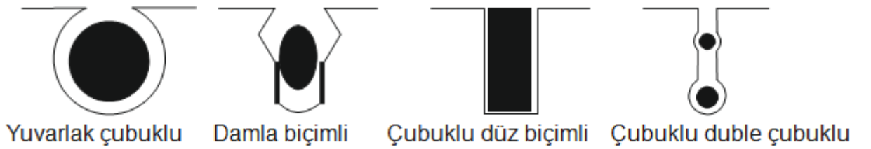
Şekil- 7.3: Rotor çubuk biçimi ve kesiti
