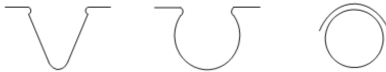
Yarı açık tip stator olukları Kapalı tip stator olukları Küçük güçlü motorlarda kullanılır.
