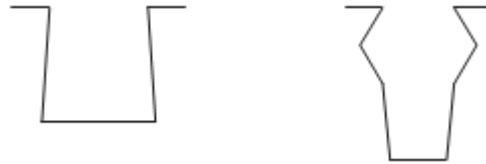
Açık tip stator sargıları Büyük güçlü motorlarda kullanılır.
