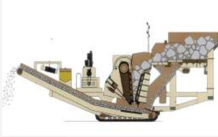
Şekil 5.3.3. Mobil gerikazanım tesisi örneği
