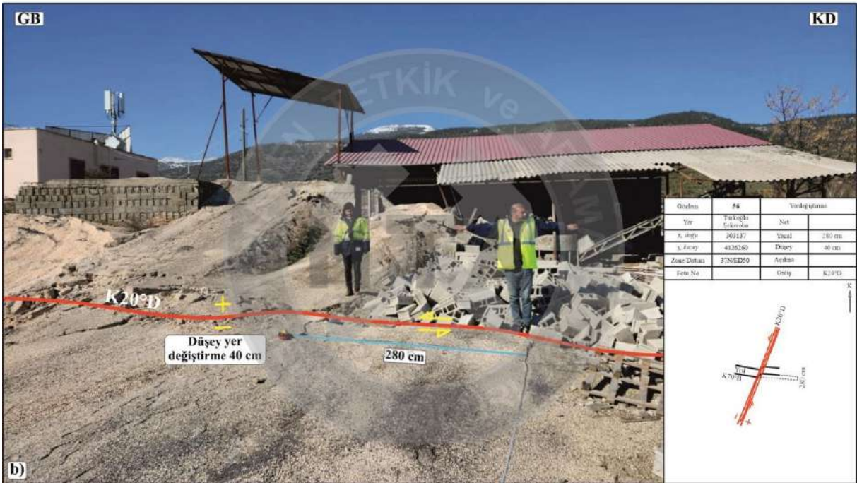
Şekil 4. 27. 06 Şubat 2023 Pazarcık (Kahramanmaraş) Depremi (Mw 7,7) sırasında Nurdağı ilçe merkezinin kuzeybatısındaki Şekeroba köyünün doğusundaki bir briket fabrikasının rampa yolunu kesen yüzey kırığına ait fotoğraf a) Yorumlanmamış b) Yorumlanmış.
